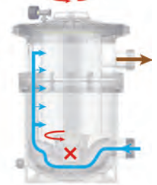
Wasserstrom in Spülung
