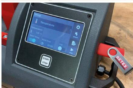
▲ Appareil de chauffage rapide Betex MF Quick-Heater : démontage de bagues de roulements en quelques minutes.
