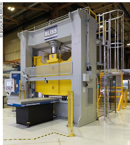
L'application développée par Bosch Rexroth permet d'automatiser deux opérations manuelles : le contrôle de positionnement des pièces sur la table et le réglage de l'inclinaison du coulisseau.
