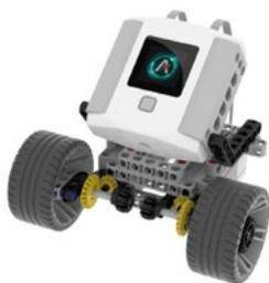
**KRYPTON 0, 1** Adatti anche ai più piccoli, questi modelli sono equipaggiati con un controller base che consente tuttavia la programmazione del robot da PC e mobile. L'alimentazione avviene tramite 6 batterie AA, incluse nella confezione.
