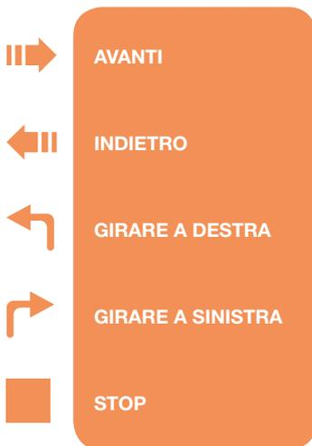
Il robot è in grado di memorizzare una sequenza di azioni. Ogni azione è costituita da una delle cinque azioni elementari. Per programmare il robot l'utilizzatore deve semplicemente premere i tasti corrispondenti in sequenza. Il robot è dotato anche di altri due tasti:
