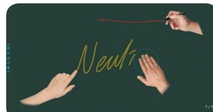
Il sistema di touch intelligente supporta il riconoscimento degli oggetti: in questo modo il tocco delle dita si trasforma in un tratto di evidenziatore, il puntatore funziona come penna ed il palmo della mano come cancellino.
