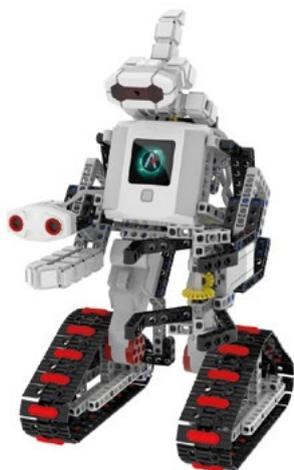
**KRYPTON 3, 5, 7, 8** Questi modelli sono equipaggiati con un controller potente e veloce da 1,3 GHz, alimentato tramite una batteria al Litio ricaricabile, e consentono di realizzare meccanismi di interazione molto evoluti grazie ai numerosi e sofisticati sensori (fino a 26 diversi sensori, tra cui una fotocamera).
