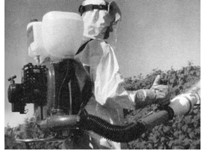
شكل ١٦. عامل رش يستخدم ميكرونيير AU8000 مركب على آلة رش ظهرية مولدة للهواء.
