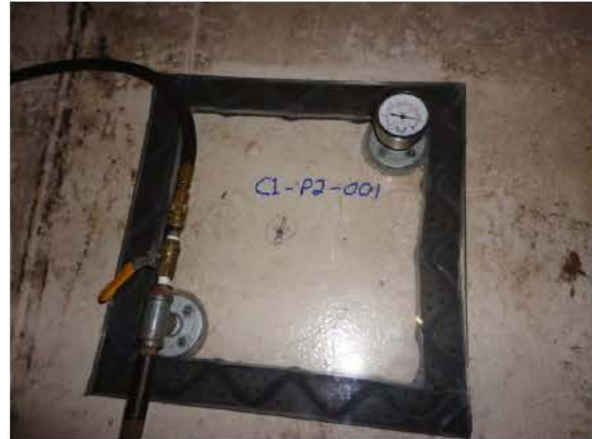
Port 001- C1 Plate 2; Vacuumed
