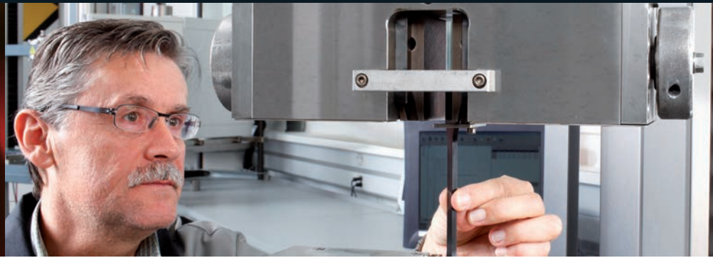
Tensile E-modulus Grivory HT2V-5H
