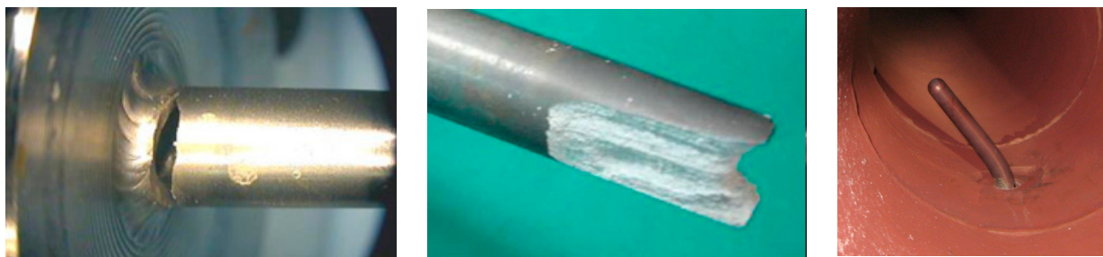
Рис. 2. Примеры отказа защитной гильзы
