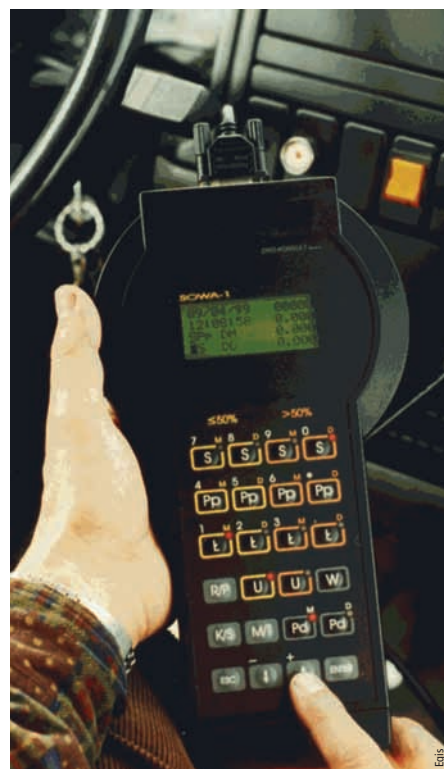
Photo 11 Système SOWA utilisé pour une inspection visuelle embarquée SOWA system used for onboard visual inspection
