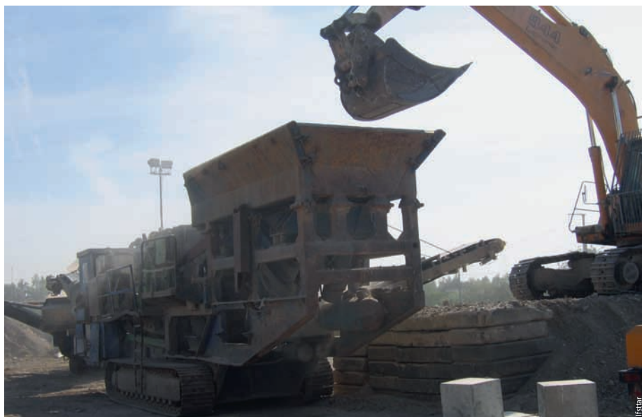
Photo 1 Concassage sur plate-forme de recyclage industrielle de blocs de béton de 40 cm d'arête coulés à l'Ifsttar On an industrial recycling platform, crushing of concrete blocks of 40cm sides cast at the IFSTTAR
