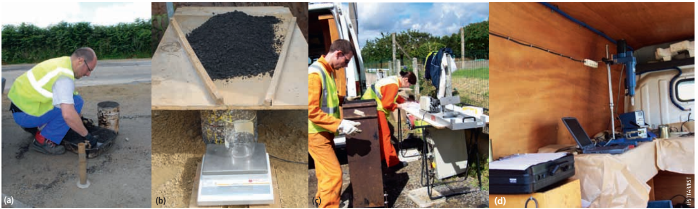
Photos 7 Préparation des prélèvements PCG (a) – Essai d'égouttage (b) - Essais de maniabilité (c) (d) Preparation of Gyrotary sampling (a) – Drainage test (b) – Maniability tests (c) (d)
