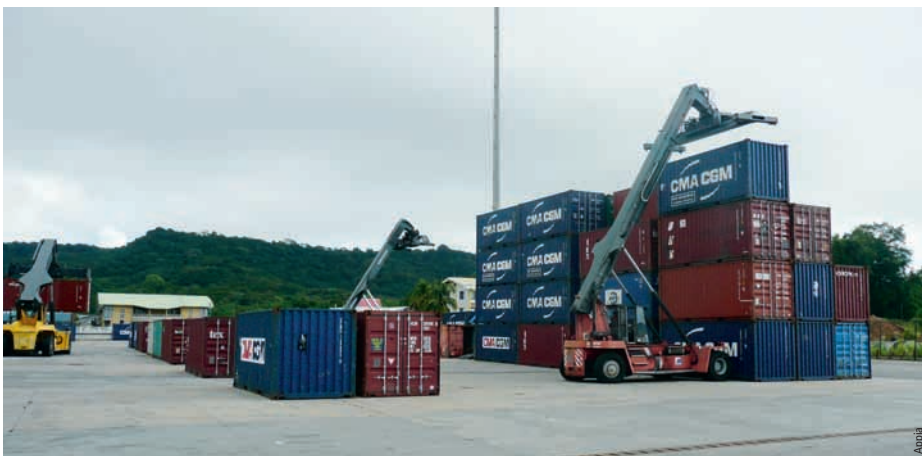
Photo 1 Manutention de conteneurs par chariots élévateurs
