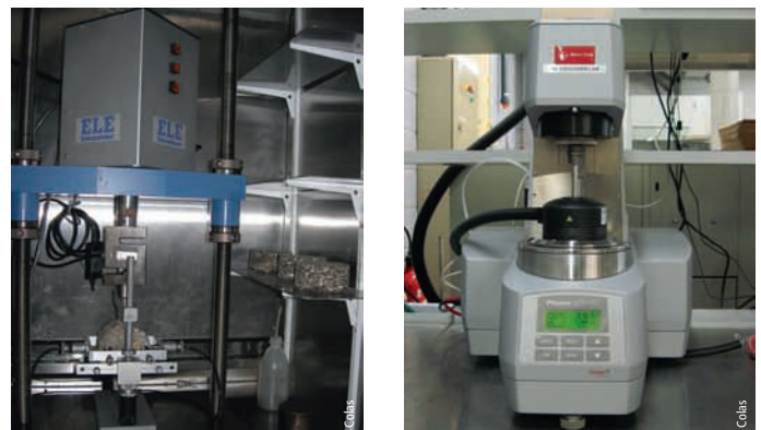
Photos 1 Presse de type UTM et viscosimètre à cisaillement dynamique Anton Paar Press of the UTM type and Anton Paar dynamic shear viscosimeter
