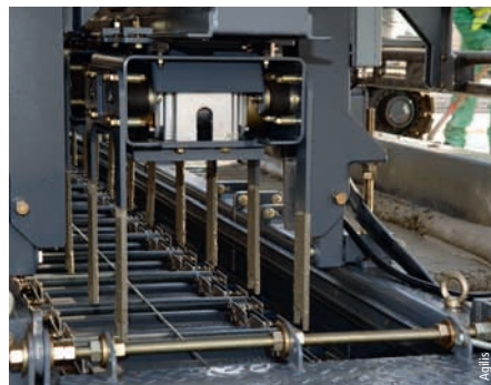
Photo 5 Le positionnement automatique des goujons
