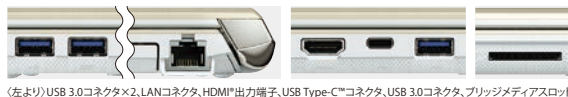
(左より)USB 3.0コネクタ×2、LANコネクタ、HDMI*8出力端子、USB Type-C™コネクタ、USB 3.0コネクタ、プリッジメディアスロット
