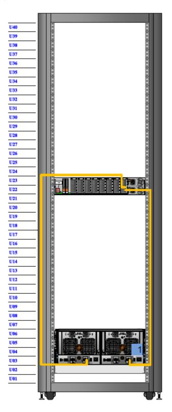
DD6300, DD6800 and DD9300 cabling
