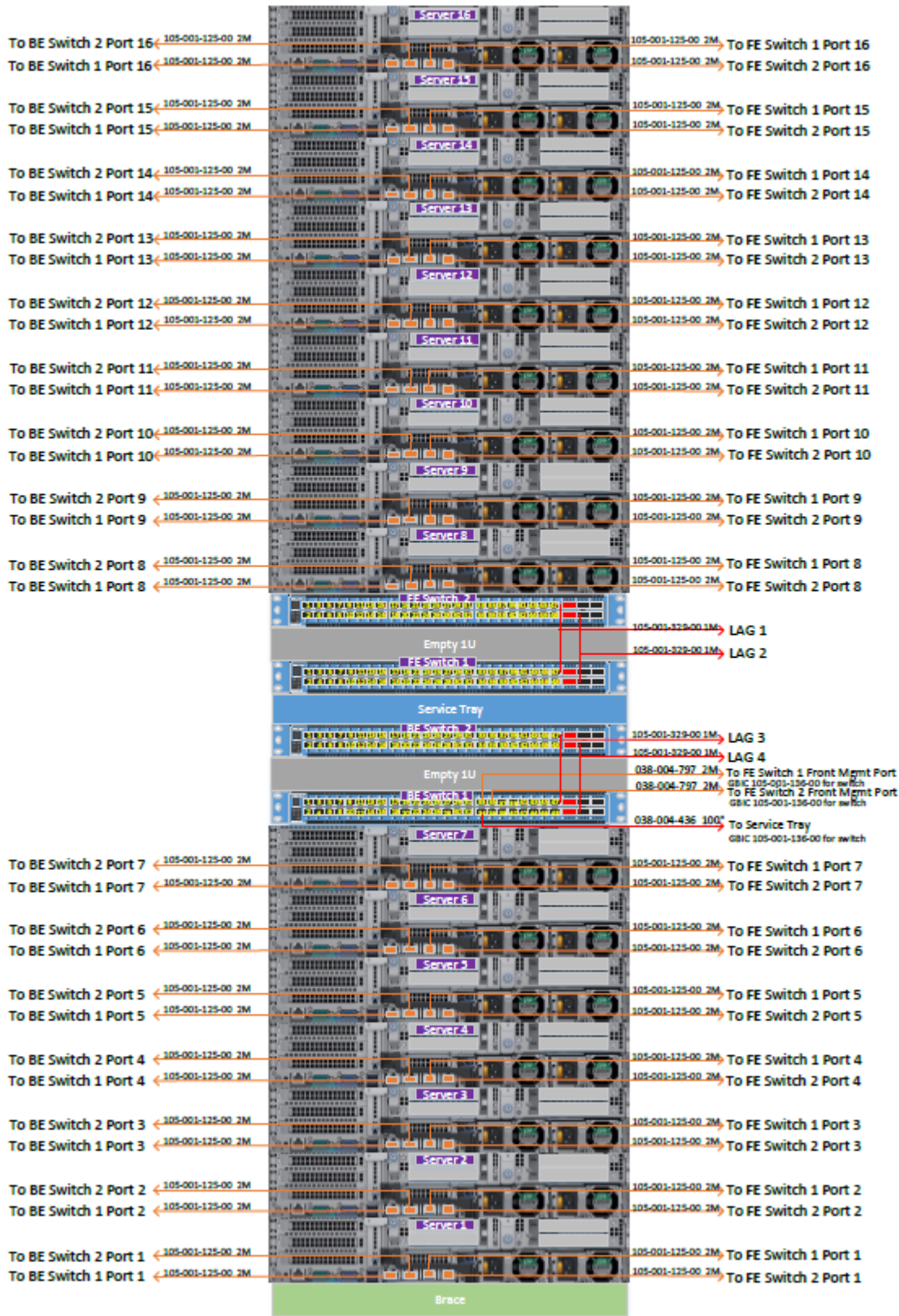
Figura 29 Cableado de red de EX300
