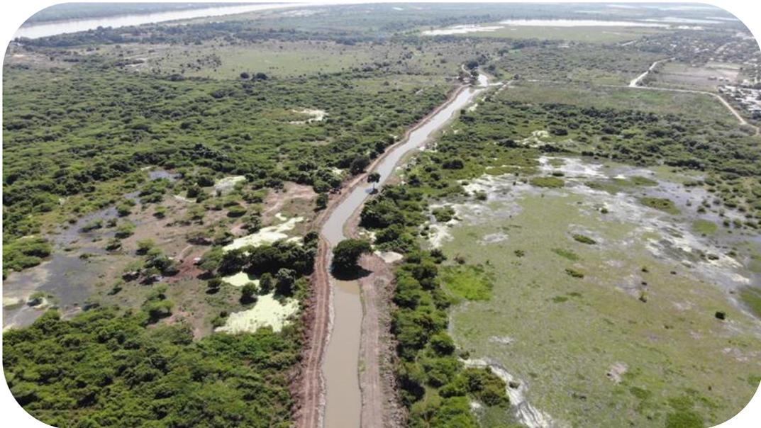
*Estado del Caño de interconexión después de la ejecución de las actividades de extracción de sedimentos y plantas hidrofitas.*
