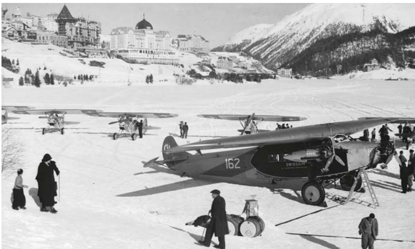
Aus Kraftstoff-Fässern, die auf der Eisfläche des St. Moritzersees lagern, werden mehrere Dewoitine D-27 III der Fliegertruppe sowie die Fokker F-VII-b 3m CH-162 der Swissair betankt.
