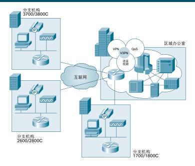
上图显示 Cisco 3800C 系列路由器可在 IPsec VPN 网络上融合安全语音、视频和数据,并提供优质可靠的性能。V3PN 功能提供 QoS、多协议、易配置性和安全连接。
