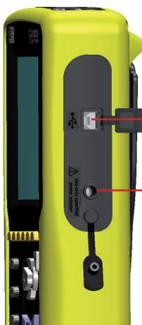
Connecteur USB. Ce connecteur permet la liaison de l'appareil avec un PC.
