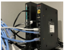
院内に設置された「VR-U500X」。縦置き可能なため設置面積が少なく済む
