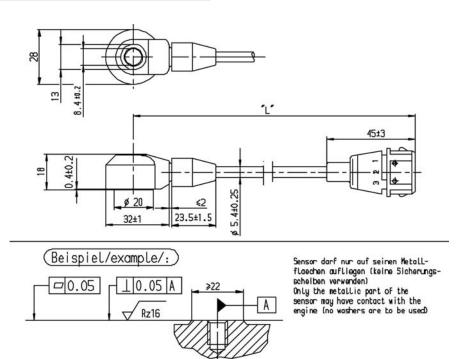
Auflagefloeche soll rotationssymmetrisch zur Gewindebohrung bearbeitet werden. The contact surface must be machined rotationally symmetrical to the threaded bore.
