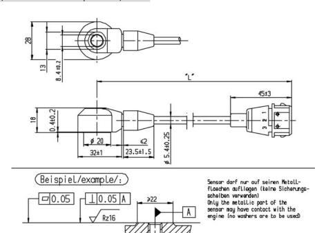
Auflageflœche soll rotationssymmetrisch zur Gewindebohrung bearbeitet werden. The contact surface must be machined rotationally symmetrical to the threaded bore.
