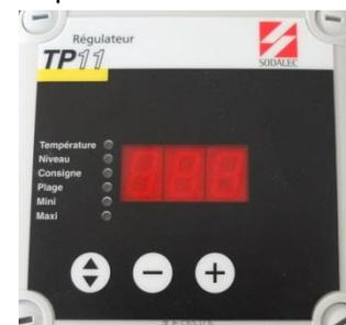
Ces paramètres sont modifiables en intervenant directement sur le pupitre du thermostat TP 11. Pour accéder aux réglages du thermostat TP 11 il convient de démonter le caisson de ventilation de son embase. Pour se faire, retirer les 6 vis M6 de fixation. La sur-longueur du câble d'alimentation et de la sonde de température laissée dans le coffret permet ainsi d'accéder au pupitre du régulateur sans le débrocher.
