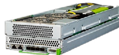
Nodo de servidor 2 Sockets, 1U, 2/4 por chasis CX400 (máx. 2x)
