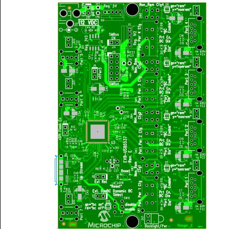
FIGURE 1-1: TOP LEVEL SILK SCREEN AND COPPER LAYER
