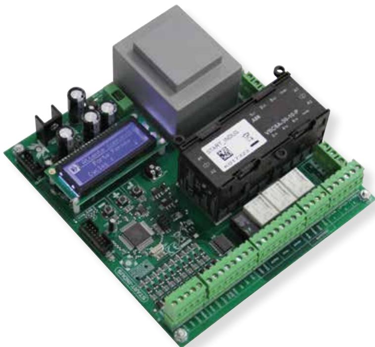
L'armoire de commande Start-indus permet de piloter tout automatisme équipé d'un moteur 230 ou 400V, mono ou tri, avec ou sans fin de course.
