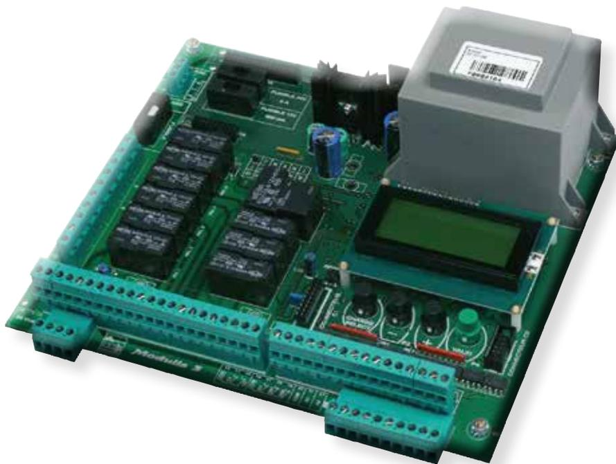
Les armoires Modulis sont à commande digitale programmable 100 % française, conçue et réalisée pour répondre à l'ensemble des besoins concernant la commande et la sécurité des automatismes de fermeture conformément aux prescriptions des normes EN13241-1, EN12453 et EN12978. L'armoire a été conçue pour vous faire gagner du temps en facilitant les installations, la maintenance, le dépannage et ainsi réduire, voire éviter les déplacements.
