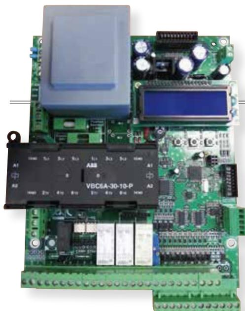
Issue du savoir faire AFCA, **STARTÉCO 4** bénéficie des dernières évolutions en matière de sécurité avec en plus du contrôle permanent du microprocesseur par un « watch dog chien de garde », un superviseur extérieur garantissant une sécurité accrue de celui ci par son contrôle permanent.
