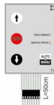
Clavier auto-manu pour STARTÉCO 3 Clavier adhésif avec 4 boutons sensitifs (limande L=50cm) (ouverture/fermeture/ stop/sélecteur auto- marche forcée)
