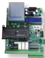
Platine seule STARTECO 4 CE avec contacteurs Code : FTU4CA00
