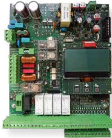
STARTECO PLUS sortie 2 moteurs 230 Vac Coffret MÉTAL vertical Code : FTY2PMOV
