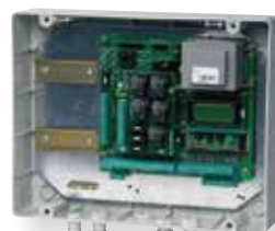
MODULIS 3 sans carte moteur pour piloter un moteur à contacteurs intégrés ou variateur Coffret PVC Code : FTW3P001
