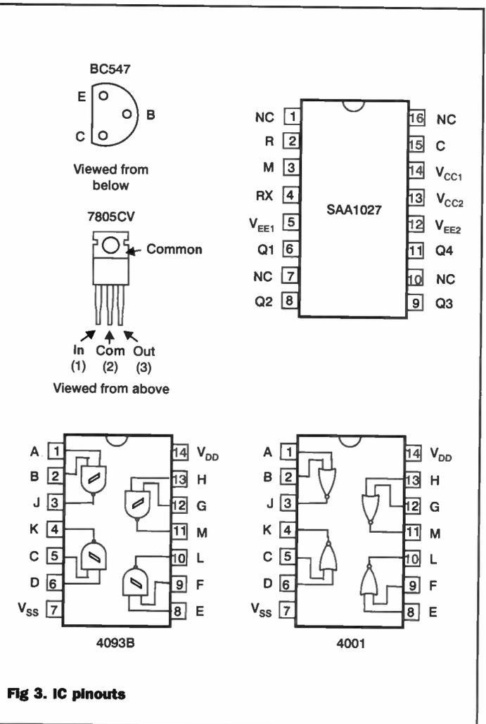
Fig 3. IC pinouts
