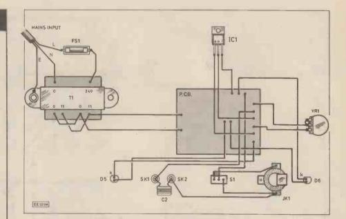
Fig. 4. Wiring diagram.
