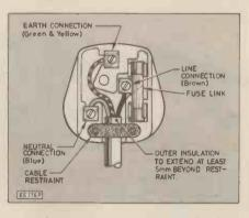
Fig. 14. Correct method of wiring a 13A plug.
