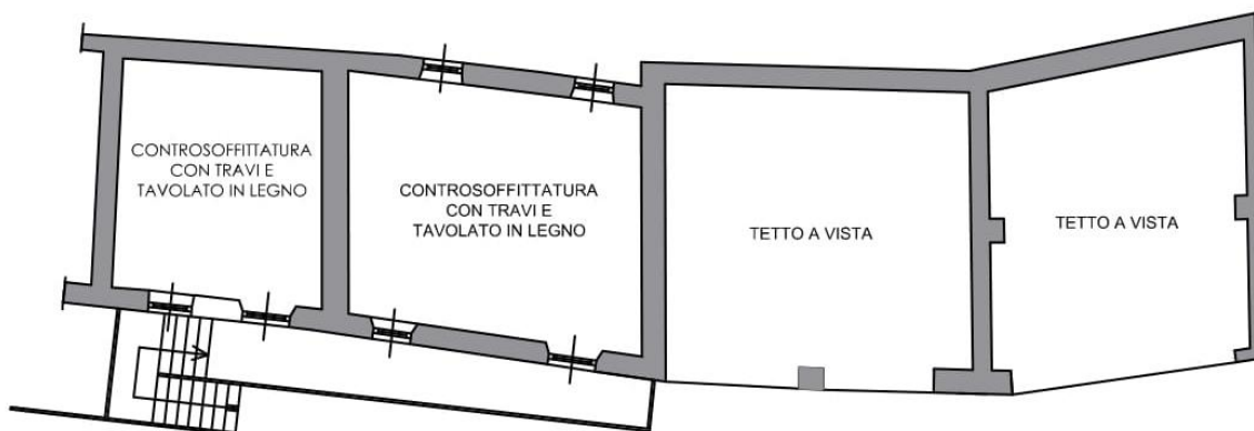
Immagine 4.9 – Controsoffittature piano primo.
