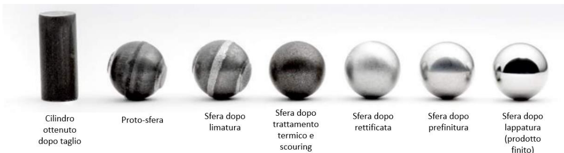
Figura 4 Sfera nelle varie fasi del processo di produzione
