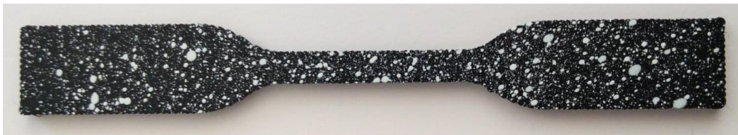
Figura 26. Probeta con moteado blanco (Elaboración propia)
