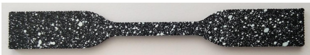
Figura 2. Probeta en forma de haltera (Elaboración propia)
