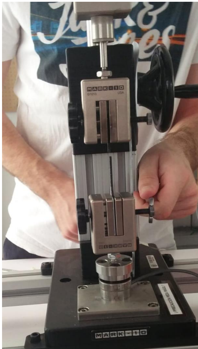
Figura 27. Ajuste de las mordazas (Elaboración propia)
