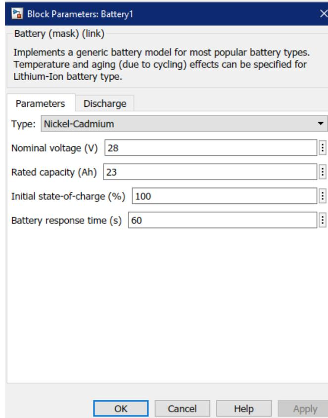
Figure 146 - Batteries parameters
