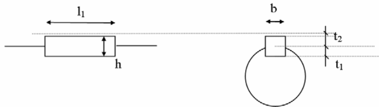
Fig. G.3.1 Dimensiones de la chaveta según Normas DIN
