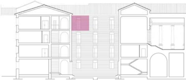
Figura 8.32– Sezione in cui viene evidenziato il macroelemento considerato
