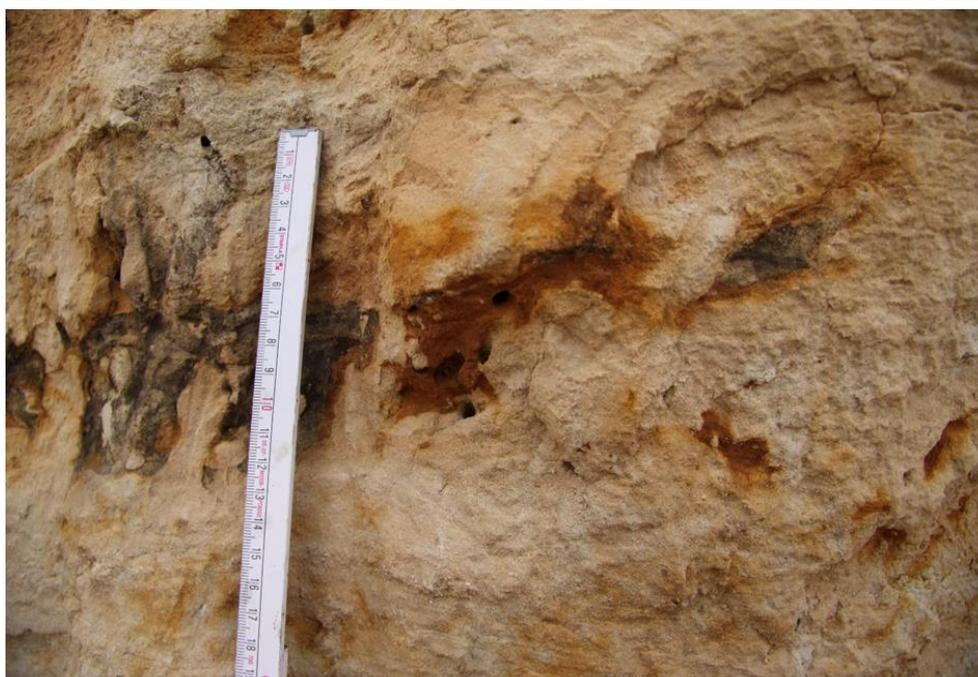
**Figure 4.8 : Détail de l'échantillon Trt 36A-25 (voir cercle figure précédente). Taches d'oxyde de fer (orange-rouille) associées à des taches noires d'oxyde de manganèse. Morphologiquement la réoxydation du fer se traduit par deux effets :**
