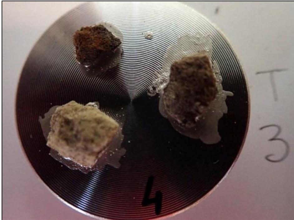
**Figure 4.2 : Echantillons collés sur un portoir a avec du nitrate d'argent.**
