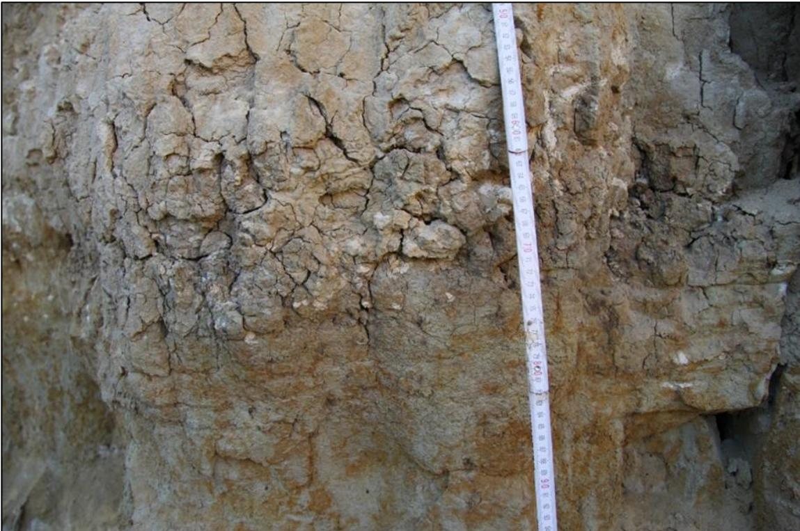
**Figure 4.36 : Détail de la limite entre l'ensemble A et B du niveau II (limite D5-D6 de la figure 4.34) soulignée par un niveau argileux présentant des traces de microfissuration du retrait des argiles gonflantes lors du séchage.**
