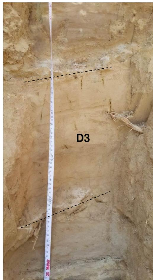
Figure 4.33 : Détail de la strate D3 du niveau inférieur.
