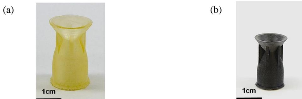
Figure I-43 : Pièces céramiques SiOC mises en forme par SLA, (a) pièce crue ; (b) pyrolysée à 1000°C sous argon [91].
