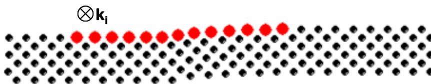
Fig. III-34 – Couche de MgO au voisinage d'une dislocation créée par montée. Les positions atomiques sont calculées d'après [80]. Les atomes de la surface considérés dans le calcul de l'intensité diffractée sont mis en évidence. Les électrons incidents ont un vecteur d'onde  $\mathbf{k}_i$  perpendiculaire au plan de la figure.
