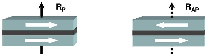
Fig. I-1 – Jonction tunnel magnétique constituée de deux électrodes ferromagnétiques séparées par une couche isolante. La direction des aimantations est représentée par les flèches blanches. La TMR est positive lorsque la résistance est plus élevée en configuration parallèle ( $R_P$ ) qu'en configuration antiparallèle ( $R_{AP}$ ).
