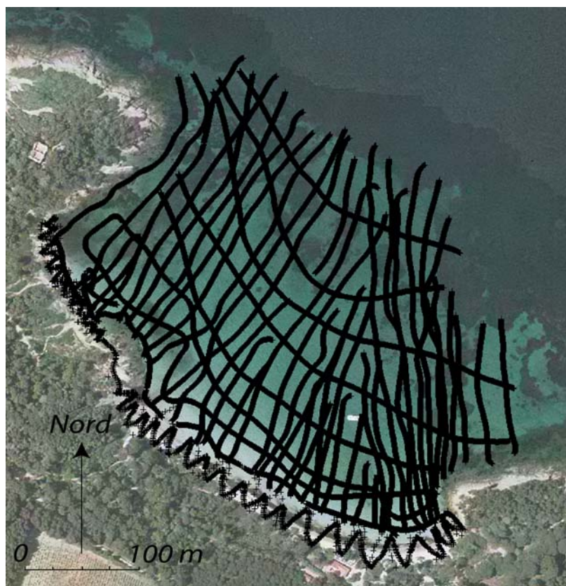
Fig. 88. Exemple de semis de sondes et de profils topographiques des levés récents (07/03/2007) sur la plage d'Argent, île de Porquerolles, sur fond orthophoto de l'IGN 2003.
