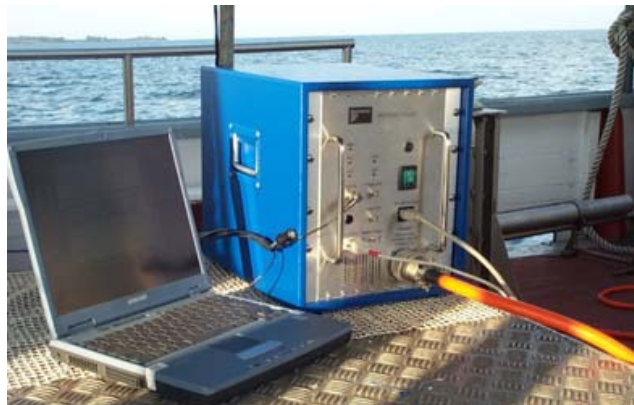
Photographie 9. Sediment Echo Sounder SES 2000 embarqué.
