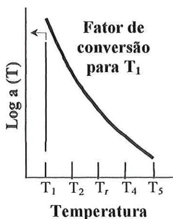
FIGURA 2.5 – Superposição tempo-temperatura (modificada de CHRISTENSEN e ANDERSON, 1992)
