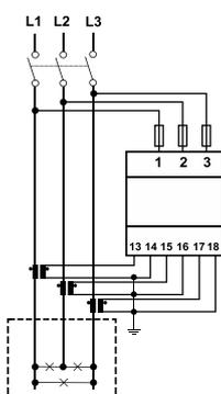
**Fig. 6** Trifásico sin neutro (3 hilos) MID
