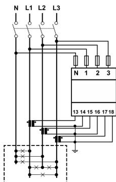
**Fig. 5** Trifásico con neutro (4 hilos)
