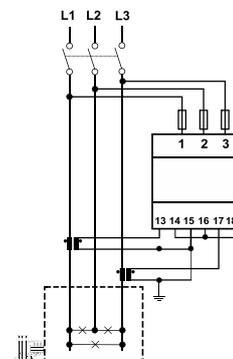
**Fig. 7** Trifásico sin neutro (3 hilos)
