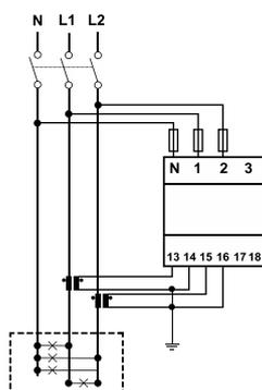
**Fig. 8** Sistema bifásico con neutro (3 hilos)
