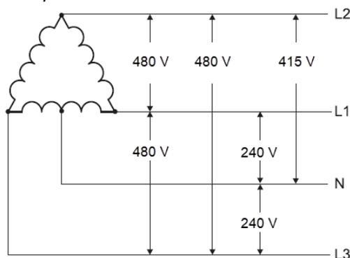
**Fig. 4** Sistema bifásico con neutro (3 hilos)
