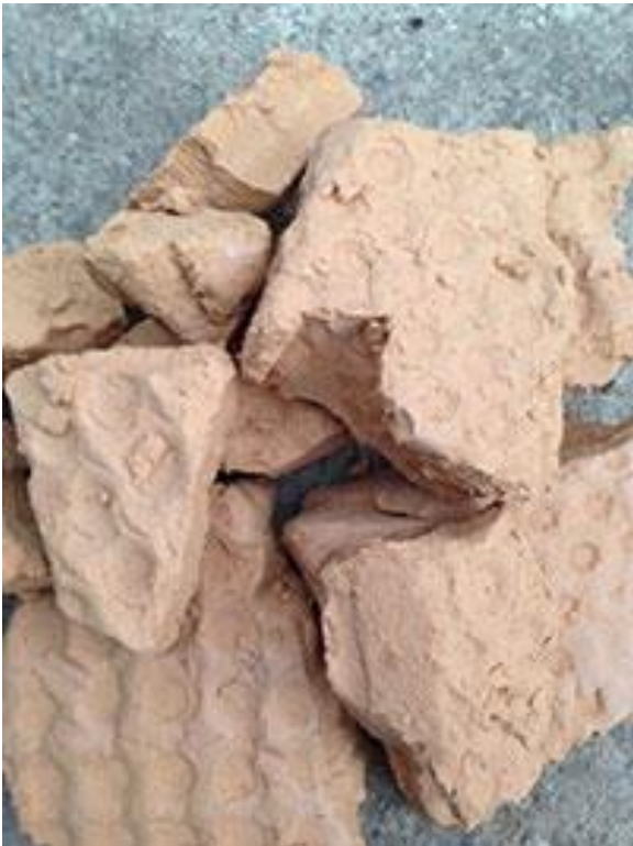
Cao lanh ( loại CL_11 sử dụng cho sản xuất gạch ceramic và loại CL_30 sử dụng cho sản xuất gạch porcelain )
