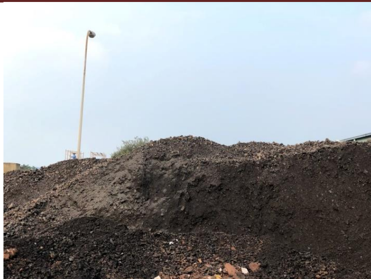
Hình 3. 26: Xi, tro than từ quá trình vận hành lò khí hóa than
