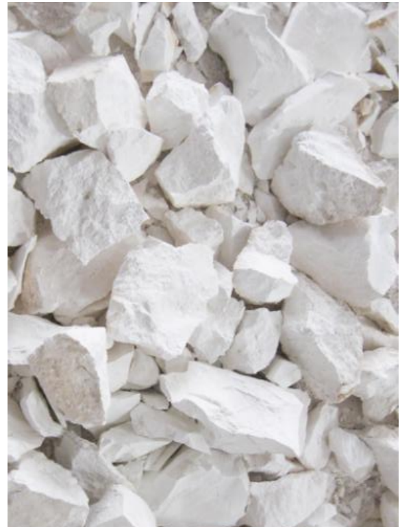
Đá vôi ( chỉ sử dụng để sản xuất gạch ceramic, không sử dụng để sản xuất gạch porcelain )
