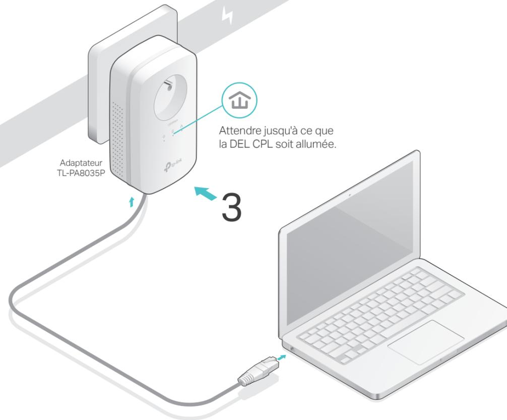
Plus : Pour ajouter des adaptateurs et des extenseurs CPL disposant de leurs paramètres par défaut, il suffit de les brancher sur le même circuit électrique.
