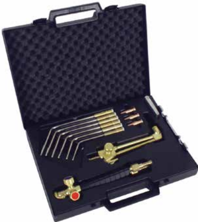
731 0 207 Palnik uniwersalny Combi 1 AD w kasecie; zakres cięcia 1-8 mm; zakres spawania 0,5-4,0 mm, dysze HA411
