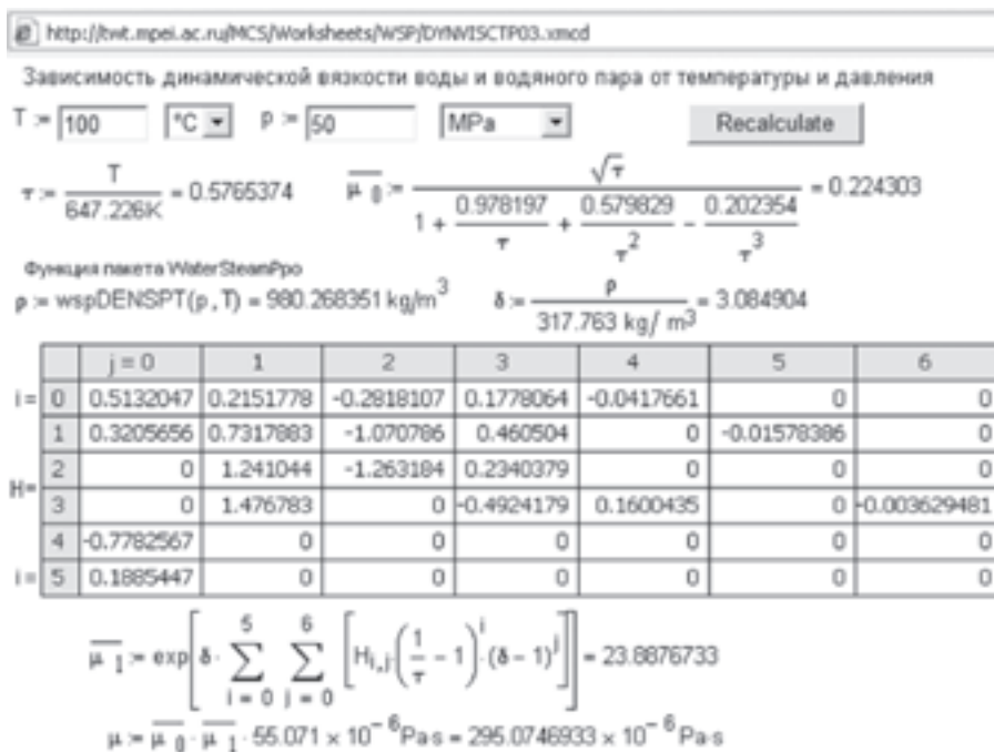
Рис. 1. Сетевой расчет, использующий функцию пакета WaterSteamPro, возвращающей плотность воды и водяного пара в зависимости от давления p и температуры T, что позволяет рассчитать динамическую вязкость по открытому алгоритму.
