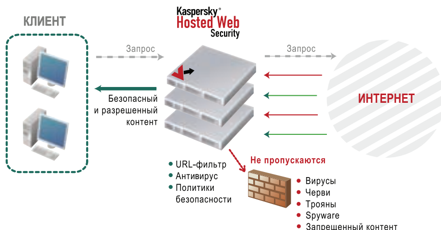
Рис. 2. Схема фильтрации Kaspersky Hosted Web Security
