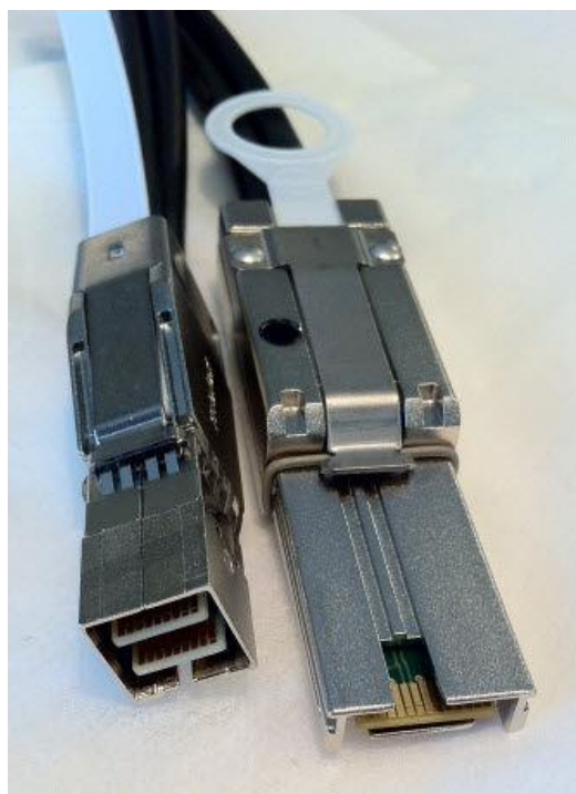
Рисунок 18. Разъемы соединения модуля ввода-вывода SAS узла 0 к хост-порту CX0-1122-15.
