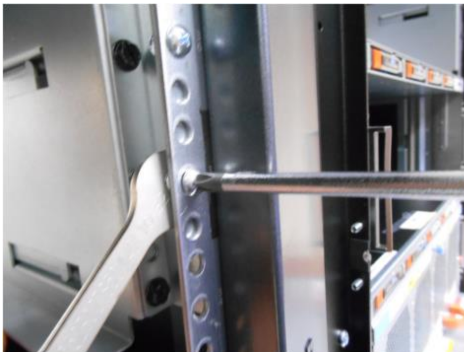
Рисунок 11. Крепление переднего адаптера.
