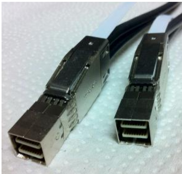
Рисунок 26. Разъемы соединения модуля ввода-вывода SAS к CX0-1125-60.
