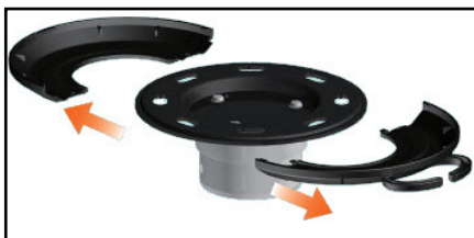
シーリングプレートカバーの取り外し
