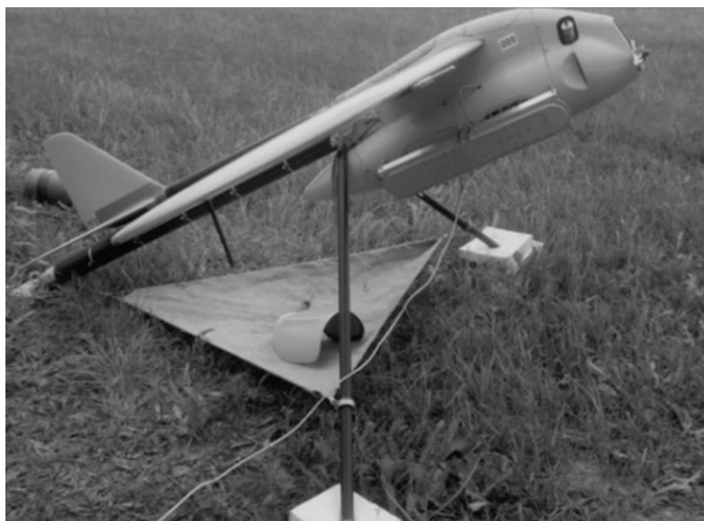
Рис. 18. БЛА «Мерлин-21Б» с РСА С-диапазона
