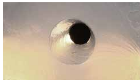
Canale di entrata simulato con pani di sapone balistici (.30-06 a 100 m)
