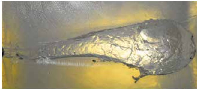
Simulazione dell'effetto d'impatto di una SPEED TIP PRO calibro .300Win. Mag a 350m
