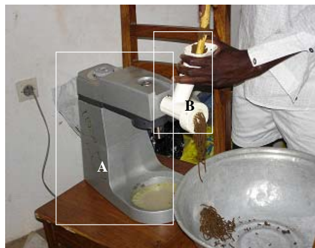
Fig. 3 : Fabrication d'aliment ; A : robot mixer ; B : hachoir électrique.
