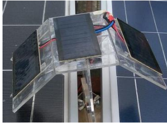
Gambar 3.20 Sel surya sebagai sensor solar irradiance
