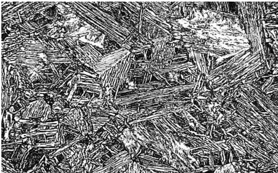
Fig. 17 – Fotomicrografia de aço baixa liga mostrando a microestrutura bainita reagente, 4% picral, 2% nital, 500X
