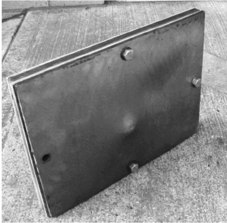
Fig. 55 – Resultado do teste balístico em Fe-0,98C-1,46Si-1,89Mn-0,26Mo-1,26Cr-0,09V, transformado a 200°C por 5 dias: vista traseira, mostrando a falta da penetração
