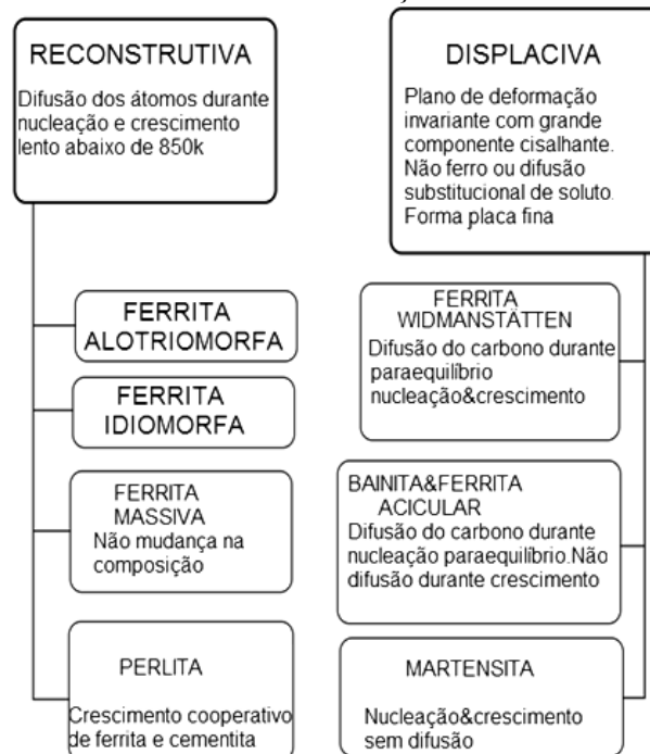
Fig. 19 – Características de transformações do estado sólido nos aços
