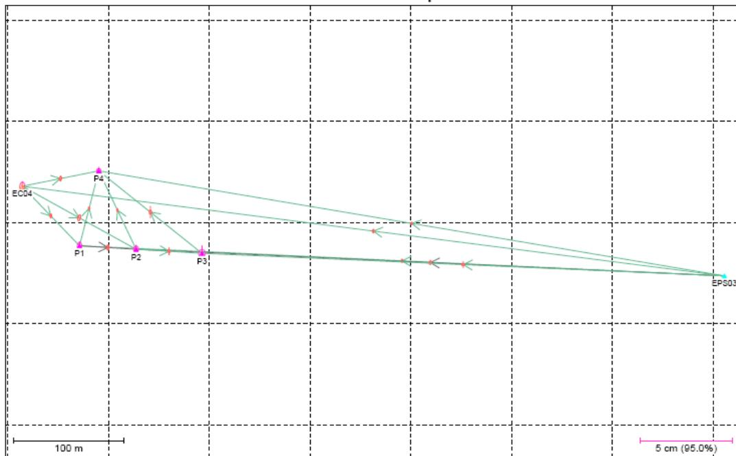
**Figura 22** – Distribuição geométrica dos vetores linhas de base observados considerando a estação de referência EPS03. Fonte: Software GrafNet.
