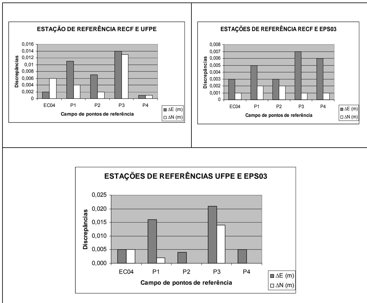
**Figura 26** - Discrepâncias de coordenadas planas retangulares UTM (E e N) entre as estações de referência distintas e apenas uma estação de referência no software GrafNet.
