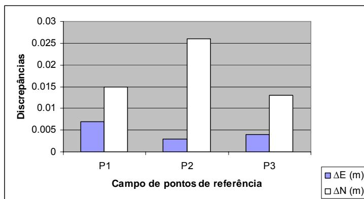
**Figura 46** - Discrepâncias entre as coordenadas planas retangulares UTM do campo de pontos de referência obtidas com GPS e por transformação de similaridade.
