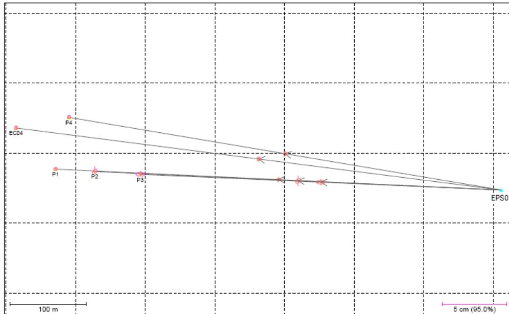
**Figura 32** – Distribuição geométrica dos vetores linhas de base observados considerando a estação de referência EPS03 com duas ocupações no campo de pontos de referência. Fonte: *Software GrafNet*.
