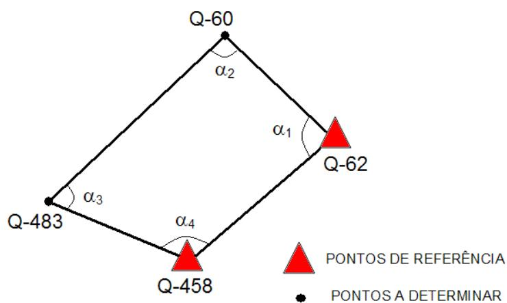
**Figura 12 – Poligonal fechada e apoiada.**
