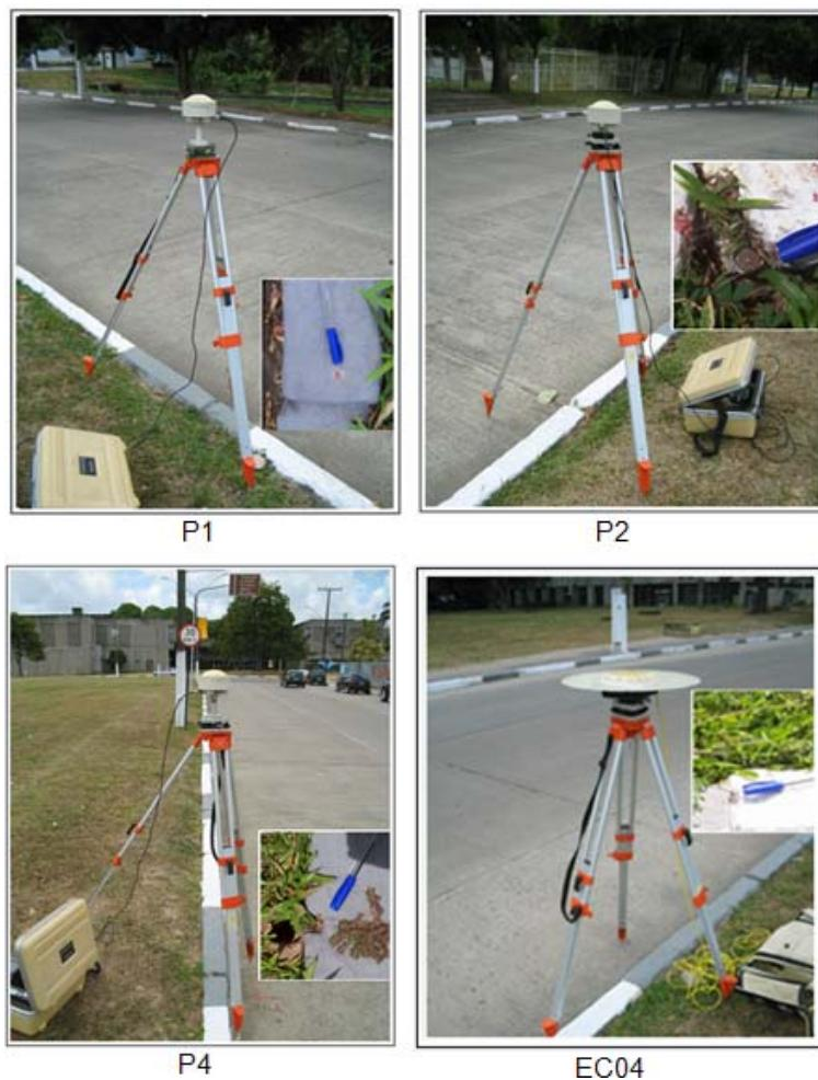
**Figura 18 – Rastreio GPS do campo de pontos de referência.**
