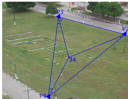
**Figura 52 – Geometria do método da interseção a vante do campo de pontos-objeto.**
