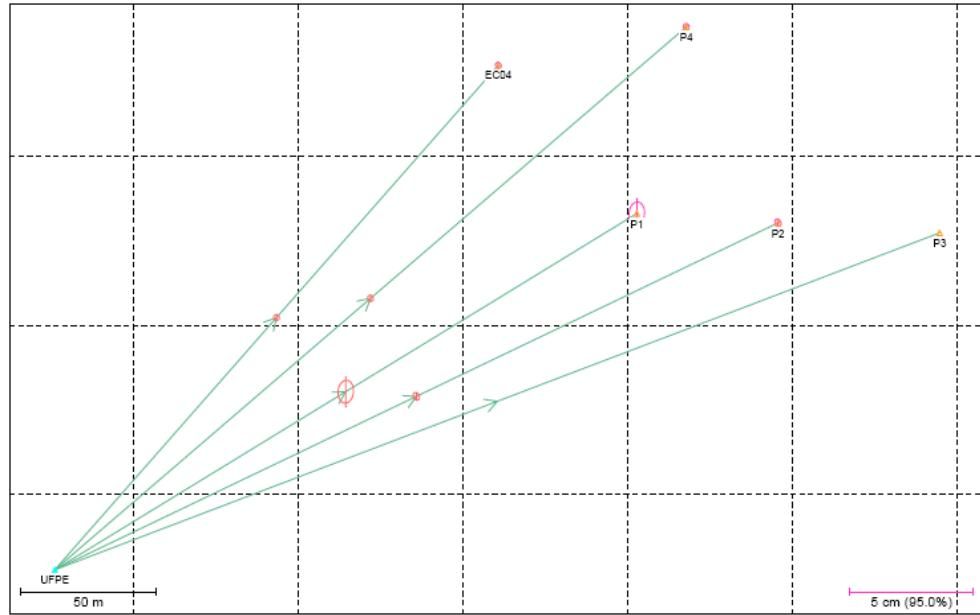
**Figura 29** – Distribuição geométrica dos vetores linhas de base observados considerando a estação de referência UFPE com uma ocupação no campo de pontos de referência. Fonte: *Software GrafNet*.
