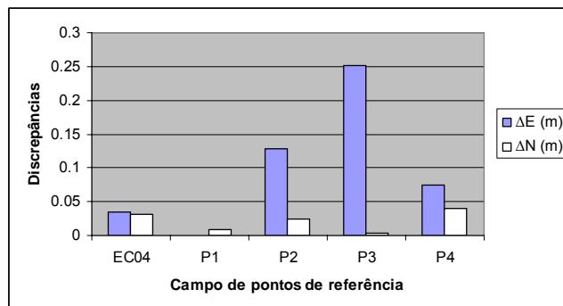
**Figura 49** – Discrepâncias entre as coordenadas planas retangulares UTM do campo de pontos de referência medidos com GPS e por transformação de similaridade.
