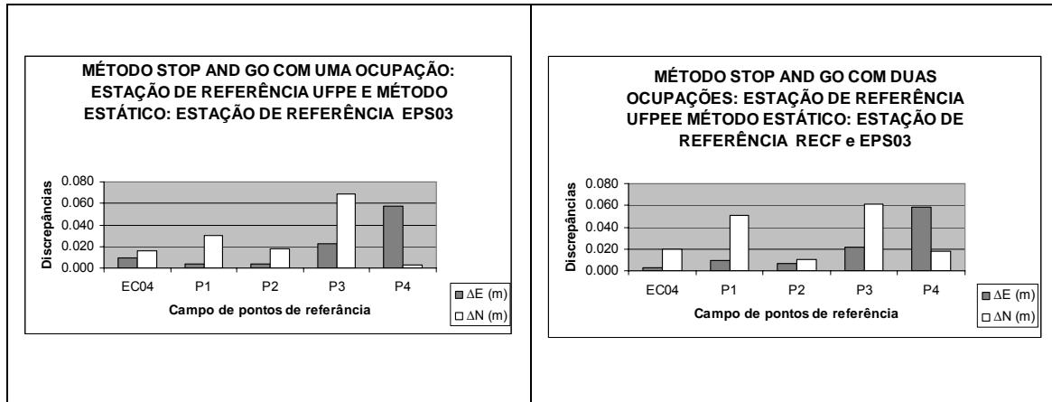
**Figura 35** – Gráficos das discrepâncias de coordenadas planas retangulares UTM (E e N) método *Stop-and-go* com uma e duas ocupações e o método estático tendo a estação EPS03 como referência.
