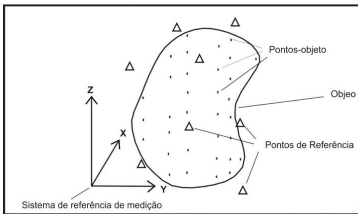
**Figura 1** - Representação do Sistema de Referência de Medição a partir dos pontos de referência. Fonte : FERREIRA et al, 2004.
