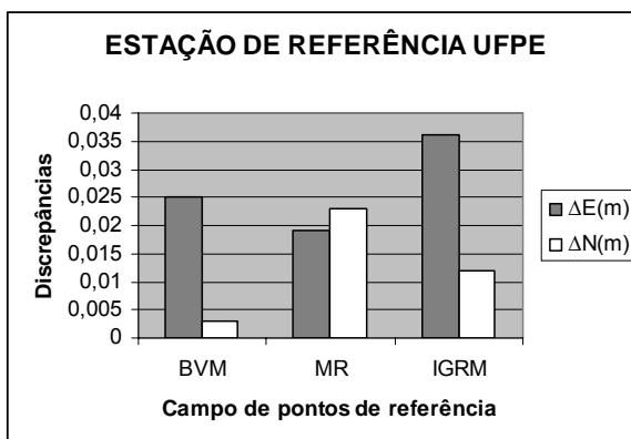
**Figura 63** - Discrepância entre as Coordenadas planas retangulares UTM das campanhas GPS realizadas em 14 de dezembro de 2007 e 11 e 16 de julho de 2008.
