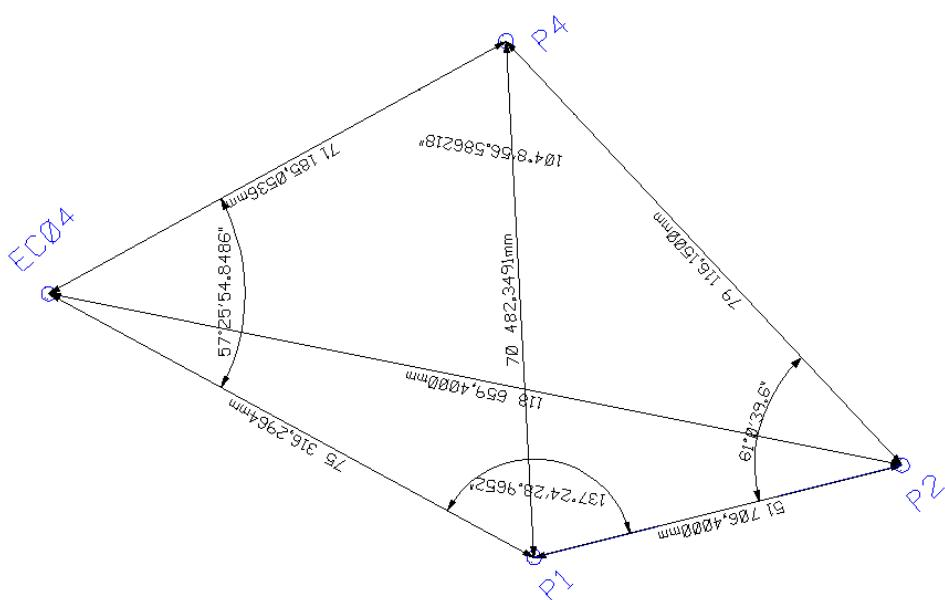
**Figura 39 – Configuração geométrica do método de rede.**
