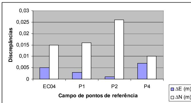
**Figura 42** – Discrepâncias de coordenadas planas retangulares UTM do campo de pontos de referência obtidas com GPS e por transformação de similaridade.
