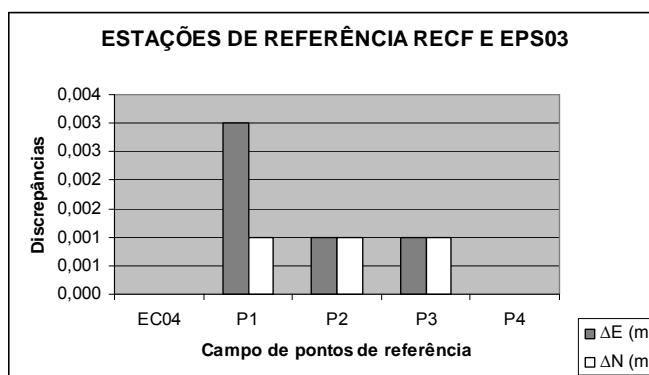
**Figura 24 –** Gráfico das discrepâncias de coordenadas planas retangulares UTM do campo de pontos de referência obtidas das estratégias de processamento do método relativo de posicionamento estático nos softwares GrafNet e TGO.
