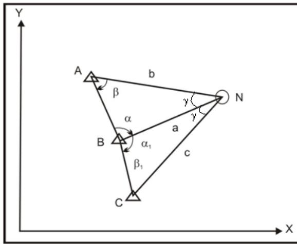
**Figura 8 - Exemplo de interseção a Vante com dois ângulos.**
