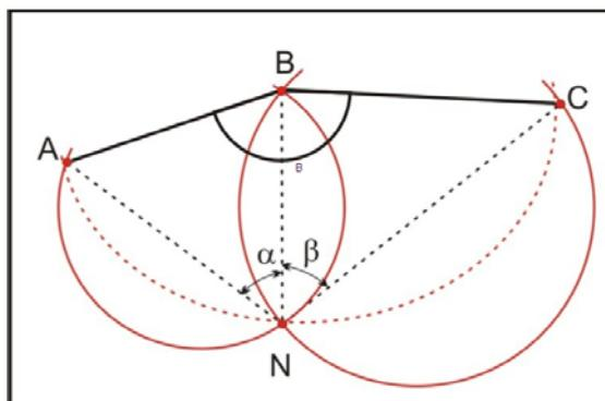
**Figura 10 – Representação geométrica da medição por interseção a ré.**
