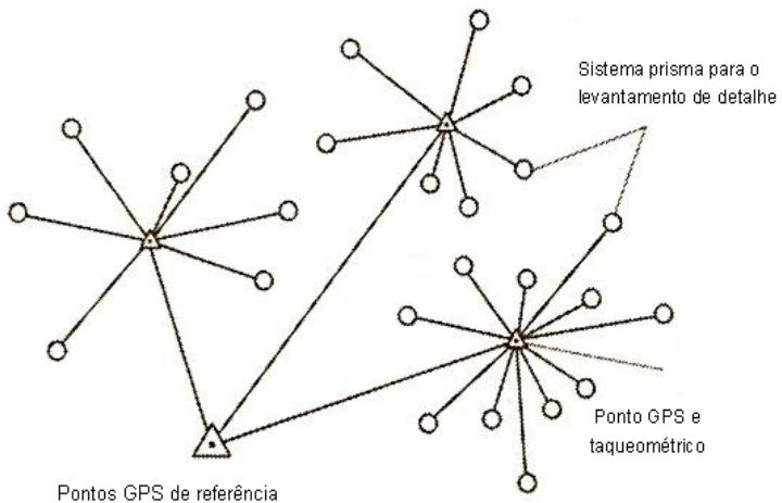
**Figura 6** - Combinação de GPS com um taqueômetro eletrônico. Fonte: SEEGER, 2003.
