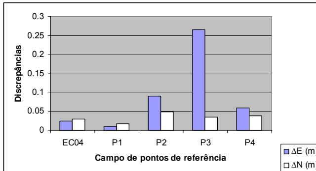
**Figura 50** - Discrepâncias entre as coordenadas planas retangulares UTM do campo de pontos de referência obtidos no sistema UTM e por transformação de similaridade.
