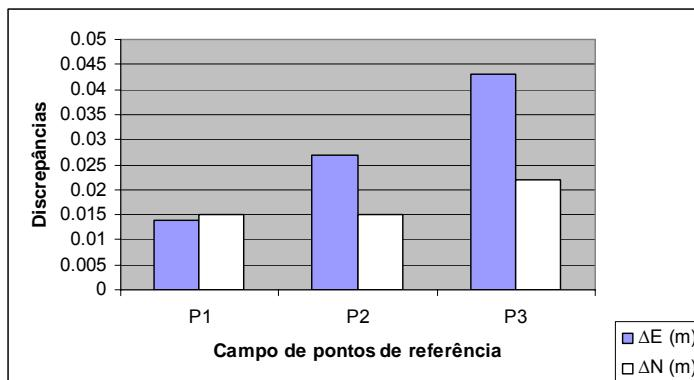
**Figura 44** - Discrepâncias entre as coordenadas planas retangulares UTM do campo de pontos de referência obtidos no sistema UTM e com GPS.
