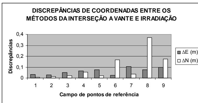
Figura 66 - Discrepâncias de coordenadas resultantes da comparação entre o método da irradiação e interseção a vante.
