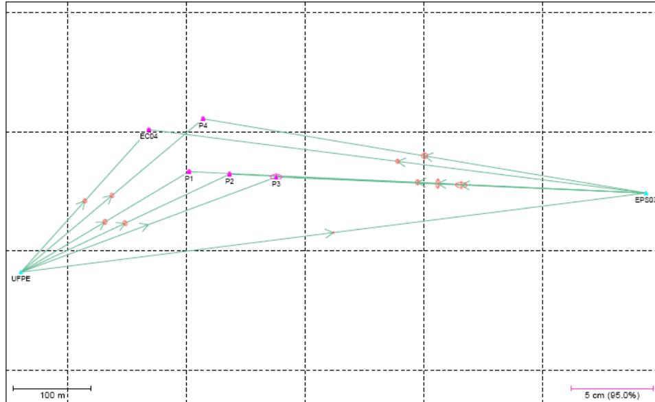
**Figura 27** - Distribuição geométrica dos vetores linhas de base observados considerando a estação de referência UFPE e EPS03 com uma ocupação e processamento simultâneo. Fonte: Software GrafNet.
