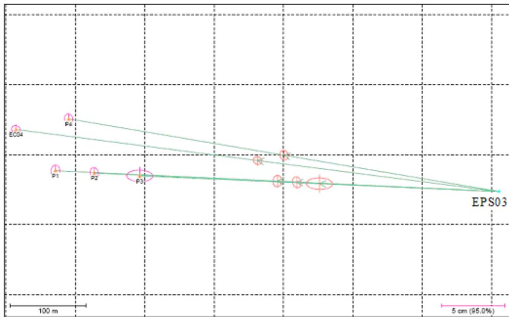
**Figura 31** – Distribuição geométrica dos vetores linhas de base observados considerando a estação de referência EPS03 com uma ocupação no campo de pontos de referência. Fonte: *Software GrafNet*.
