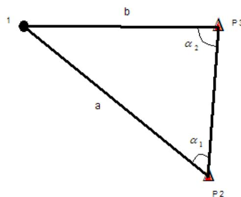
**Figura 55** – Representação geométrica do método da irradiação dupla.
