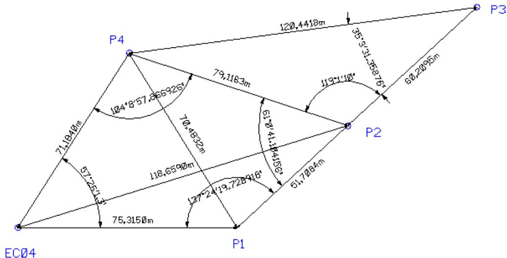
**Figura 47** – Configuração geométrica do campo dos pontos de referência por interseção a vante.
