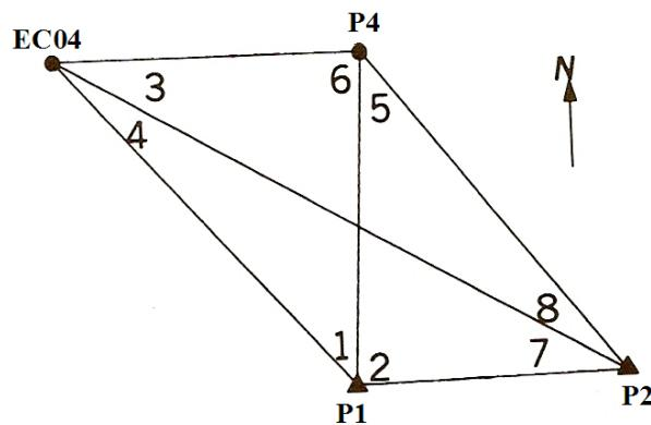
**Figura 14** – Representação de redes por triangulação. Fonte: Adaptado de WOLF e GHILANI (1996).
