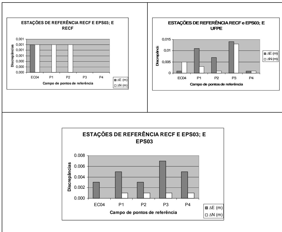
**Figura 25** – Gráfico das discrepâncias de coordenadas planas retangulares UTM (E e N) entre as estratégias de processamento do método de posicionamento estático no software GrafNet.
