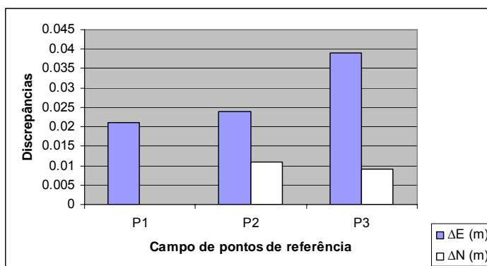
**Figura 45** - Discrepâncias entre as coordenadas planas retangulares UTM do campo de pontos de referência obtidos no sistema UTM e por transformação de similaridade.
