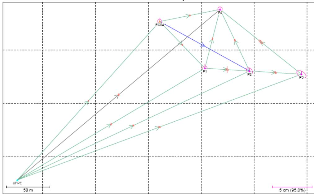
**Figura 21** – Distribuição geométrica dos vetores linhas de base observados considerando a estação de referência UFPE. Fonte: Software GrafNet.
