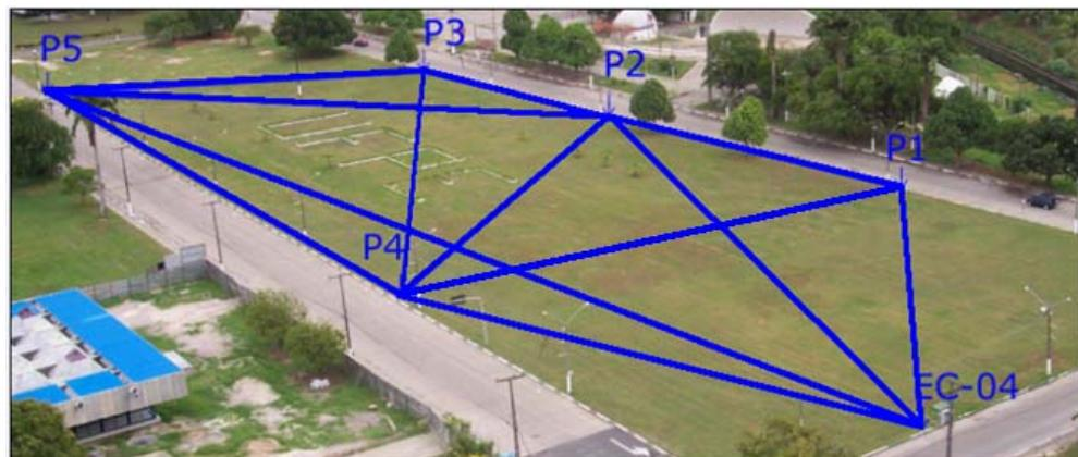
**Figura 37** – Representação do campo de pontos de referência e dos irradiamentos realizados nos vértices do campo de pontos de referência.
