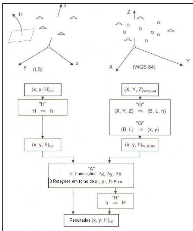
**Figura 3** - Transformação de um Sistema de Referência Global em um Sistema de Referência Local, onde o Fator de Escala da Rede de Origem é Preservado.
