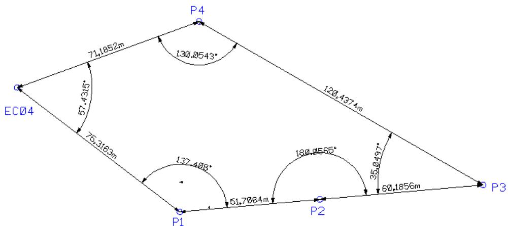
**Figura 43** – Configuração geométrica do método da poligonal fechada.
