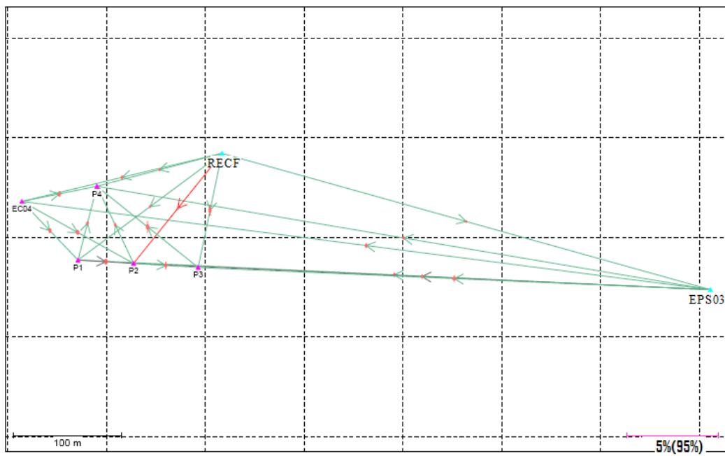
**Figura 19 – Distribuição geométrica dos vetores linhas de base observados considerando as estações de referência RECF e EPS03.** Fonte: *Software GrafNet*.
