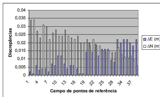
**Figura 54 -** Discrepâncias de coordenadas planas retangulares UTM em SIRGAS 2000 e resultantes planimétricas do campo de pontos-objeto provenientes da transformação de coordenadas por similaridade de Helmert.
