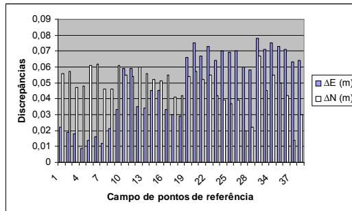
**Figura 53** - Discrepâncias entre as coordenadas planas retangulares UTM em SIRGAS 2000 e integração GPS/ Estação Total - Método da interseção a vante.
