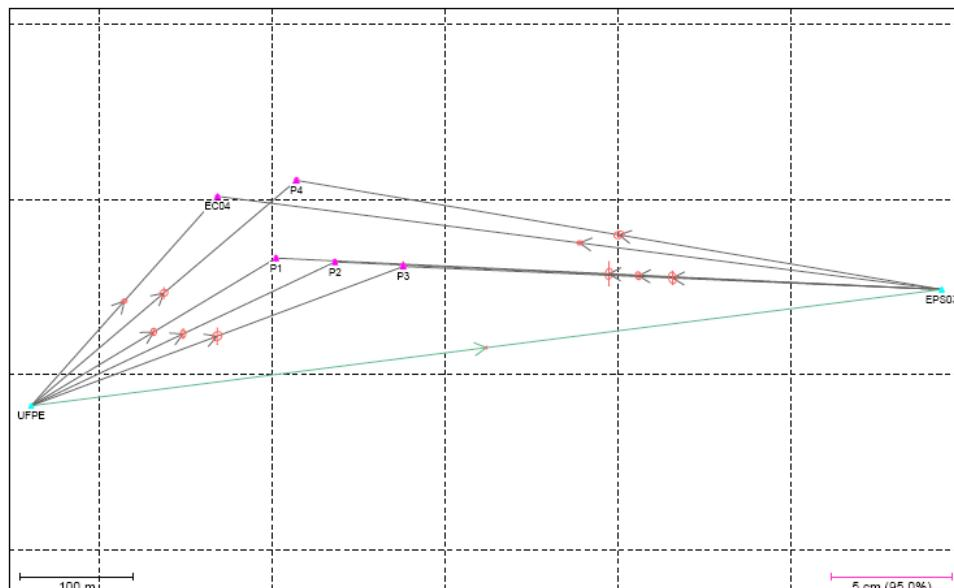
**Figura 28** - Distribuição geométrica dos vetores linhas de base observados considerando a estação de referência UFPE e EPS03 com duas ocupações e processamento simultâneo. Fonte: Software GrafNet.
