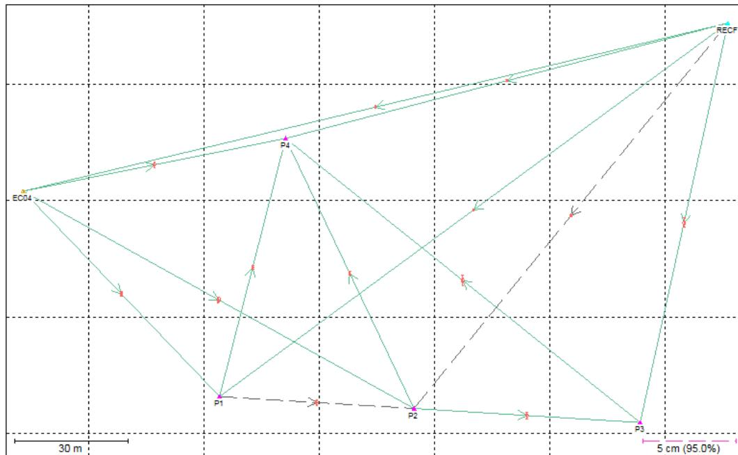
**Figura 20** - Distribuição geométrica dos vetores linhas de base observados considerando a estação de referência RECF. Fonte: Software GrafNet.
