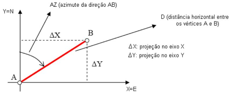
**Figura 11 –** Método da Irradiação. Adaptado de VEIGA et al (2007).
