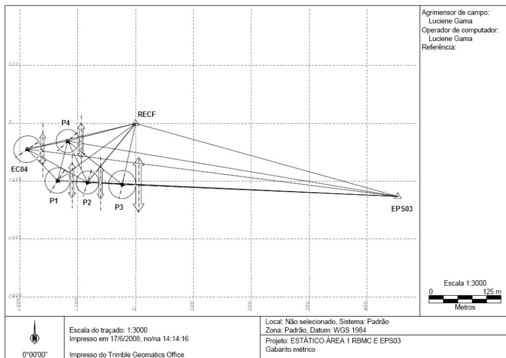
**Figura 23 – Distribuição geométrica dos vetores linhas de base observados considerando as estações de referência RECF e EPS03. Fonte: Software TGO.**
