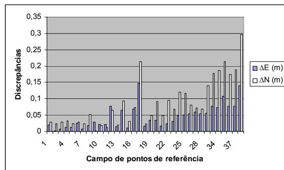
**Figura 56** – Gráfico das discrepâncias entre as coordenadas planas retangulares UTM do campo de pontos-objeto calculadas pelo método da interseção a vante e as coordenadas calculadas por irradiação dupla.
