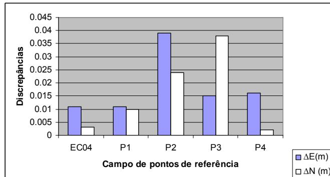
**Figura 48** - Discrepâncias entre as coordenadas planas retangulares UTM do campo de pontos de referência obtidos no sistema UTM e por GPS.
