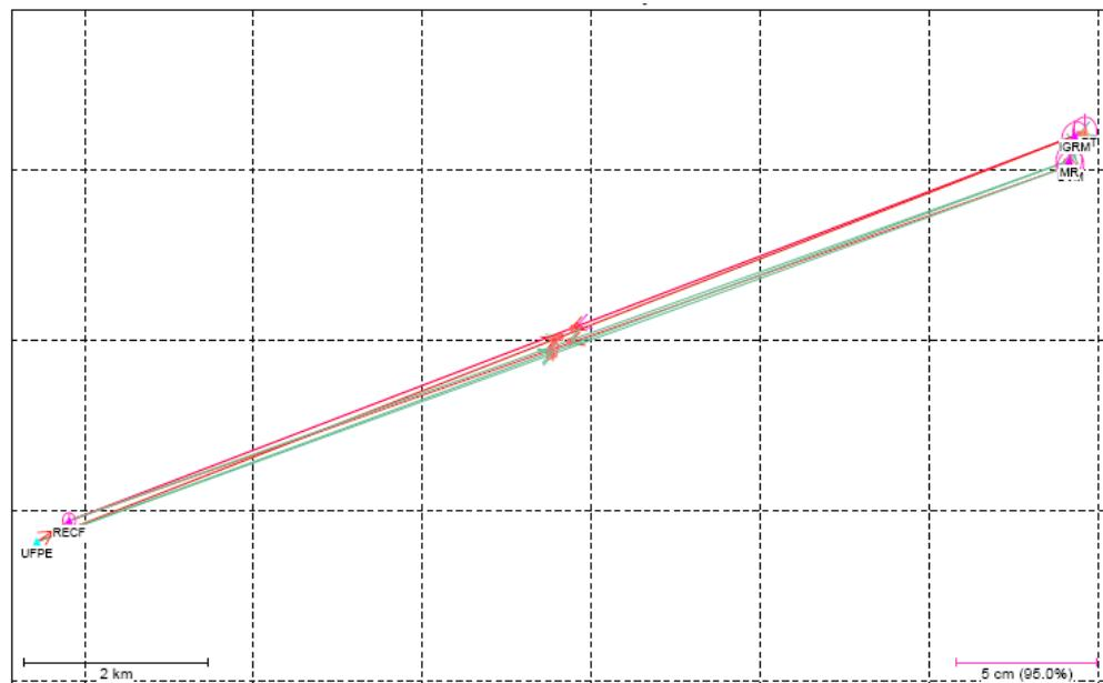
**Figura 62** – Distribuição geométrica dos vetores linhas de base observados considerando a estação de referência UFPE. Fonte: software GrafNet.
