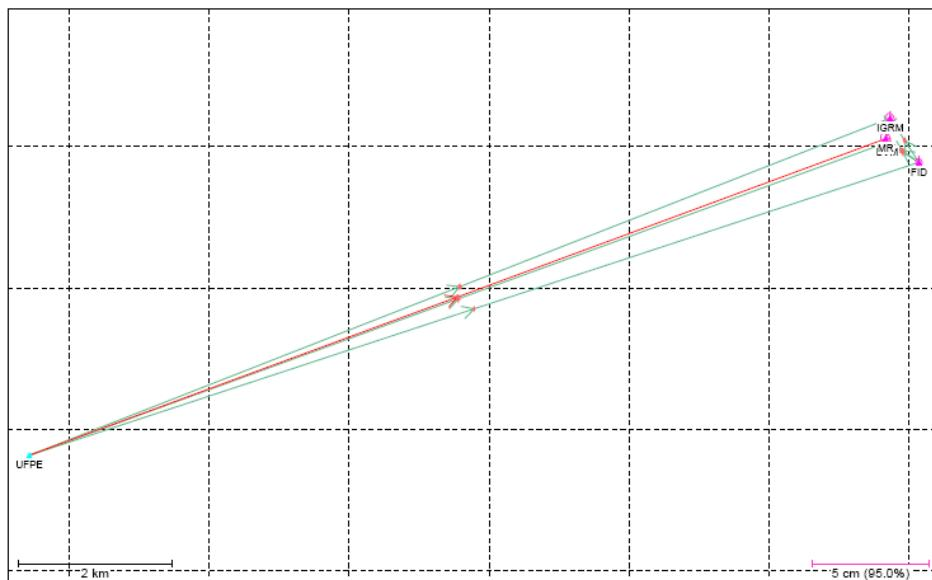
**Figura 59** – Distribuição geométrica dos vetores linhas de base observados considerando a estação de referência UFPE. Fonte: Software GrafNet.
