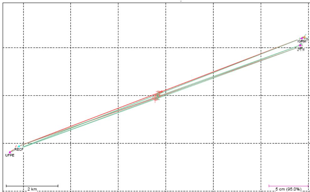
**Figura 61** – Distribuição geométrica dos vetores linhas de base observados considerando a estação de referência RECF. Fonte: Software GrafNet.
