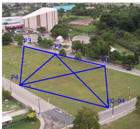
**Figura 38** – Representação do campo de pontos de referência e dos irradiamentos realizados em cada vértice adotado no trabalho.
