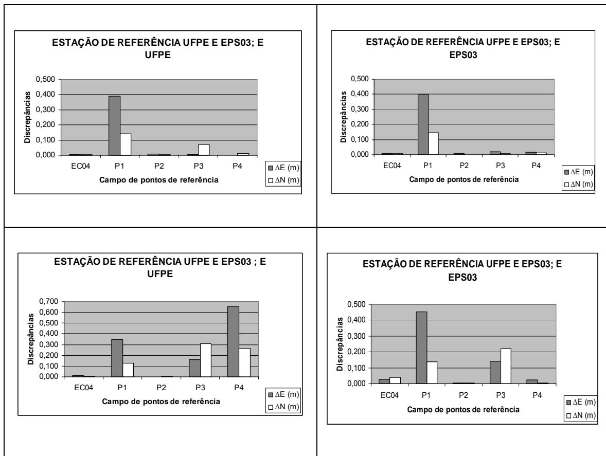
**Figura 36** – Gráficos das discrepâncias de coordenadas obtidas comparando as coordenadas planas retangulares UTM do método *Stop-and-go* com as estações de referência UFPE e EPS03 com processamento simultâneo e apenas uma estação de referência.
