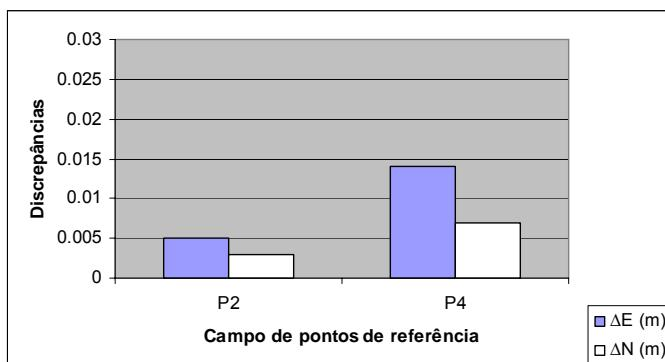
**Figura 41** - Representação gráfica das discrepâncias de coordenadas planas retangulares UTM do campo de pontos de referência obtidos no sistema UTM e por transformação de similaridade.
