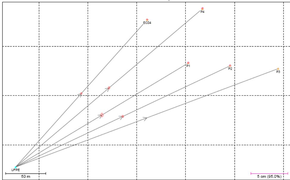
**Figura 30** – Distribuição geométrica dos vetores linhas de base observados considerando a estação de referência UFPE com duas ocupações no campo de pontos de referência. Fonte: *Software GrafNet*.
