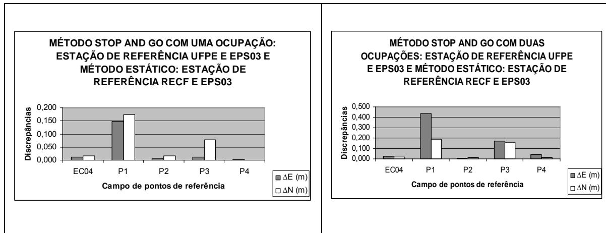
**Figura 33** – Gráficos das discrepâncias de coordenadas planas retangulares UTM (E e N): método *Stop-and-go* com uma e duas ocupações e o método estático.
