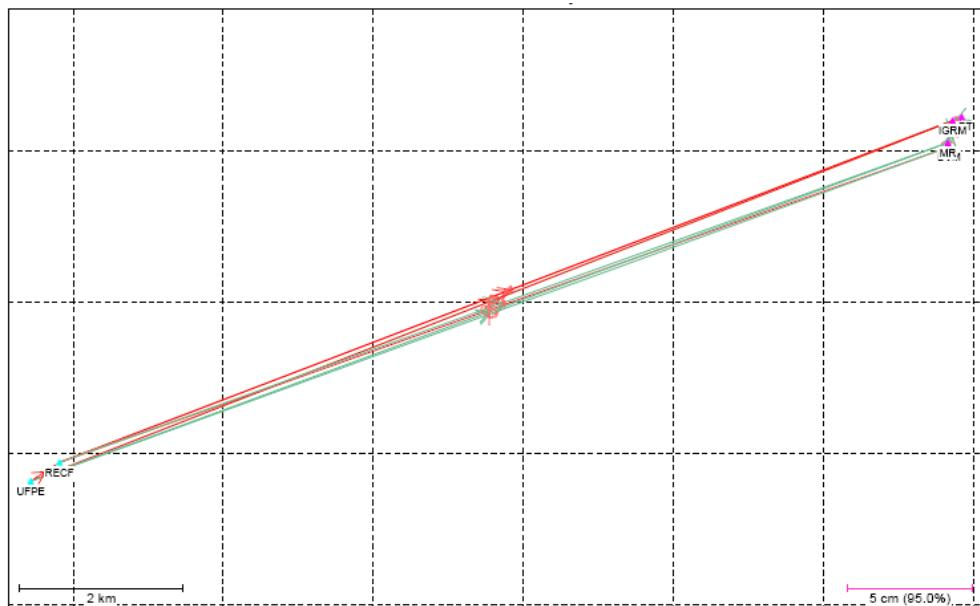
**Figura 60** – Distribuição geométrica dos vetores linhas de base observados considerando a estação de referência RECF e UFPE. Fonte: Software GrafNet.
