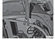
Fig. 381 Securing the door
